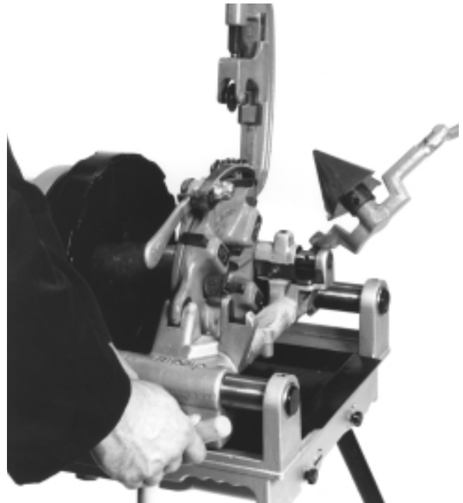
Figura 15 – Roscado con el Cabezal de Terrajas de Abertura Rápida No. 811-A
