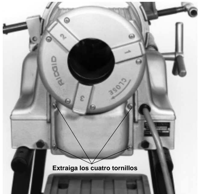
Figura 24 – Los 4 Tornillos de la tapa de la carcasa del motor
