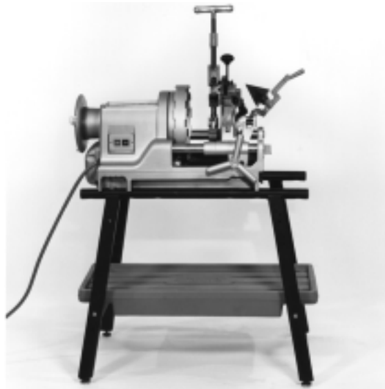
Figure 4 – Modelo 1233 montado en el soporte de patas y bandeja No.100
