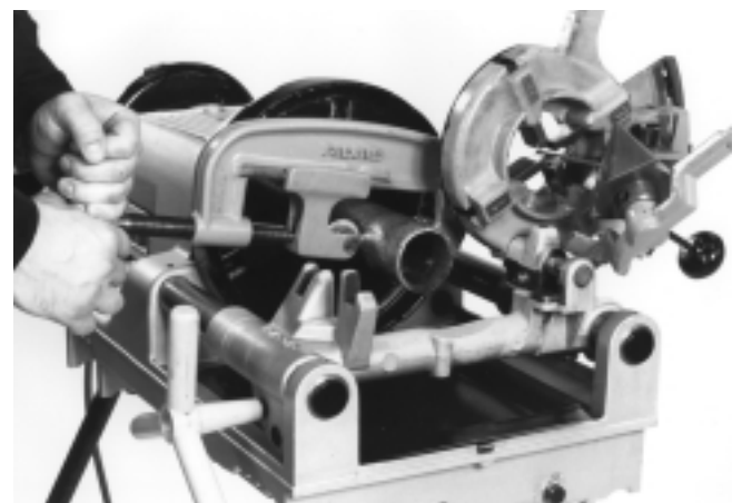
Figura 5 – Corte de un tubo con la Cortadora No. 763
