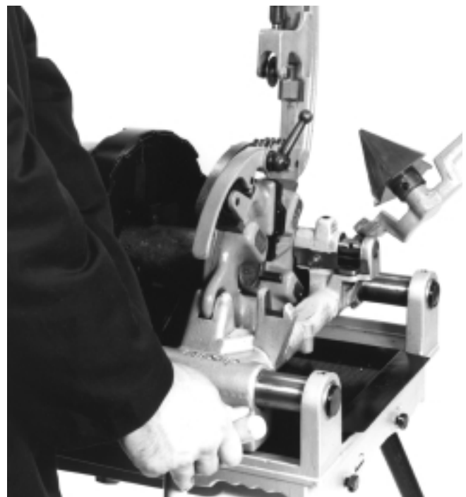
Figura 12 – Roscado con Cabezal de Terrajas de Autoapertura No. 815-A
