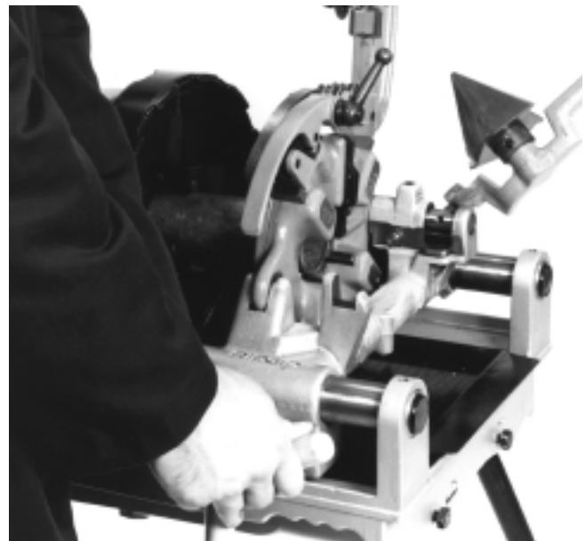
Figure 12 – Filetage avec la tête de filière à ouverture automatique 815-A
